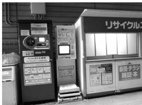
スーパーマーケット等に設置されているペットボトル処理機
