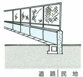
(3)高さ1.5m以下の補強コンクリート
