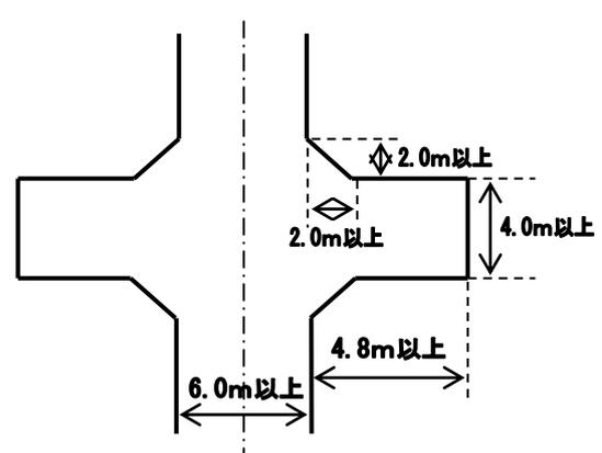
図—3 出入口構造標準図
