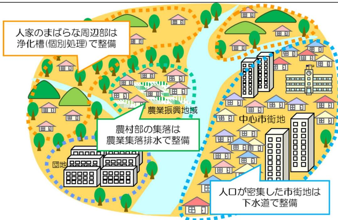
図 2 処理施設の整備手法の選定イメージ図（出典：栃木県生活排水処理構想）
