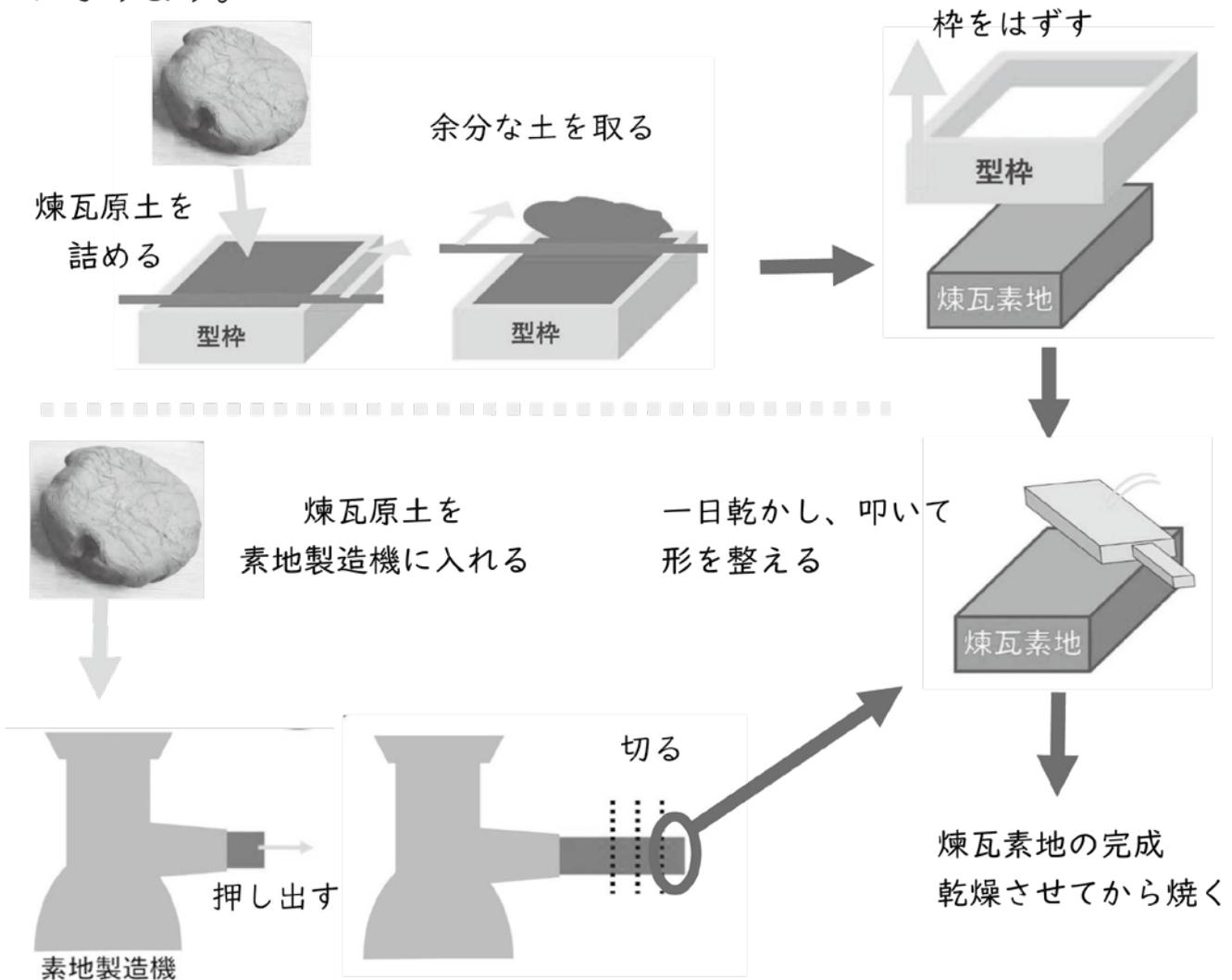
手作業で成形された煉瓦か、機械成形された煉瓦なのかは、表面を見るとわかります。手作業で成型された煉瓦の表面はなめらかですが、機械成形ではピアノ線で切ったままになるためざらざらになります。
