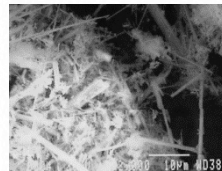
石綿(アスベスト)
